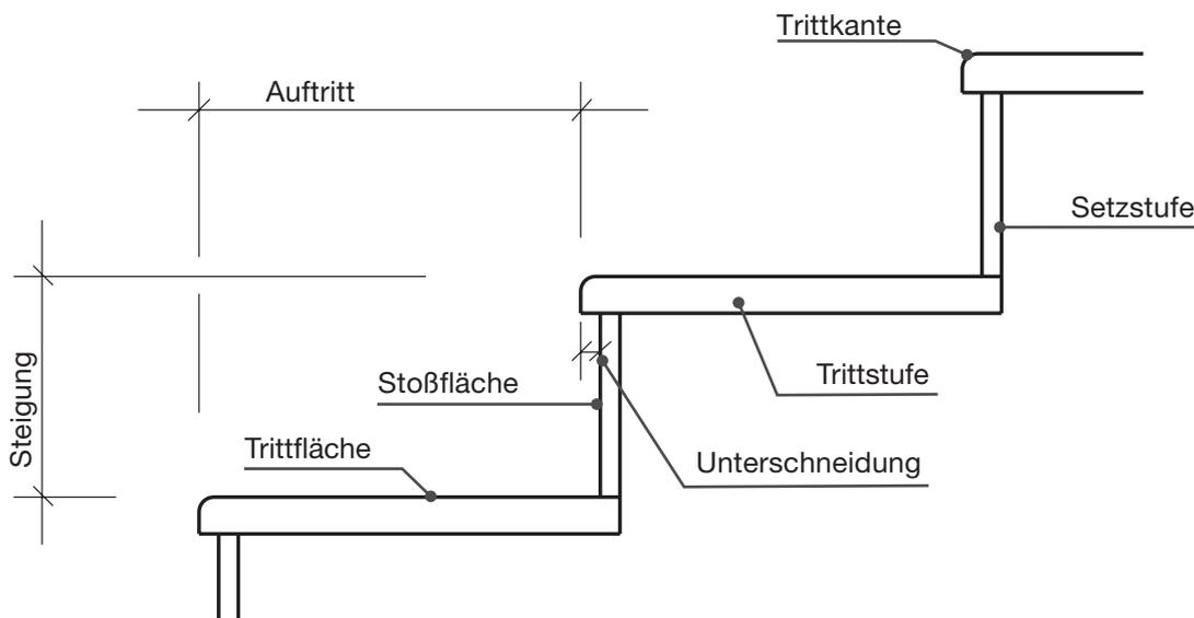
**TREPPENPLATTEN KANTE PROFILIERT, SEITLICHER ABSCHLUSS MIT SOCKELLEISTE**
